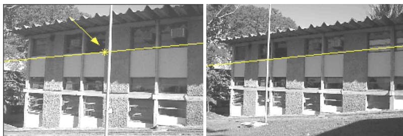
Figura 11 - Ponto selecionado na imagem esquerda, linha epipolar que passa por este ponto e a linha epipolar conjugada.
